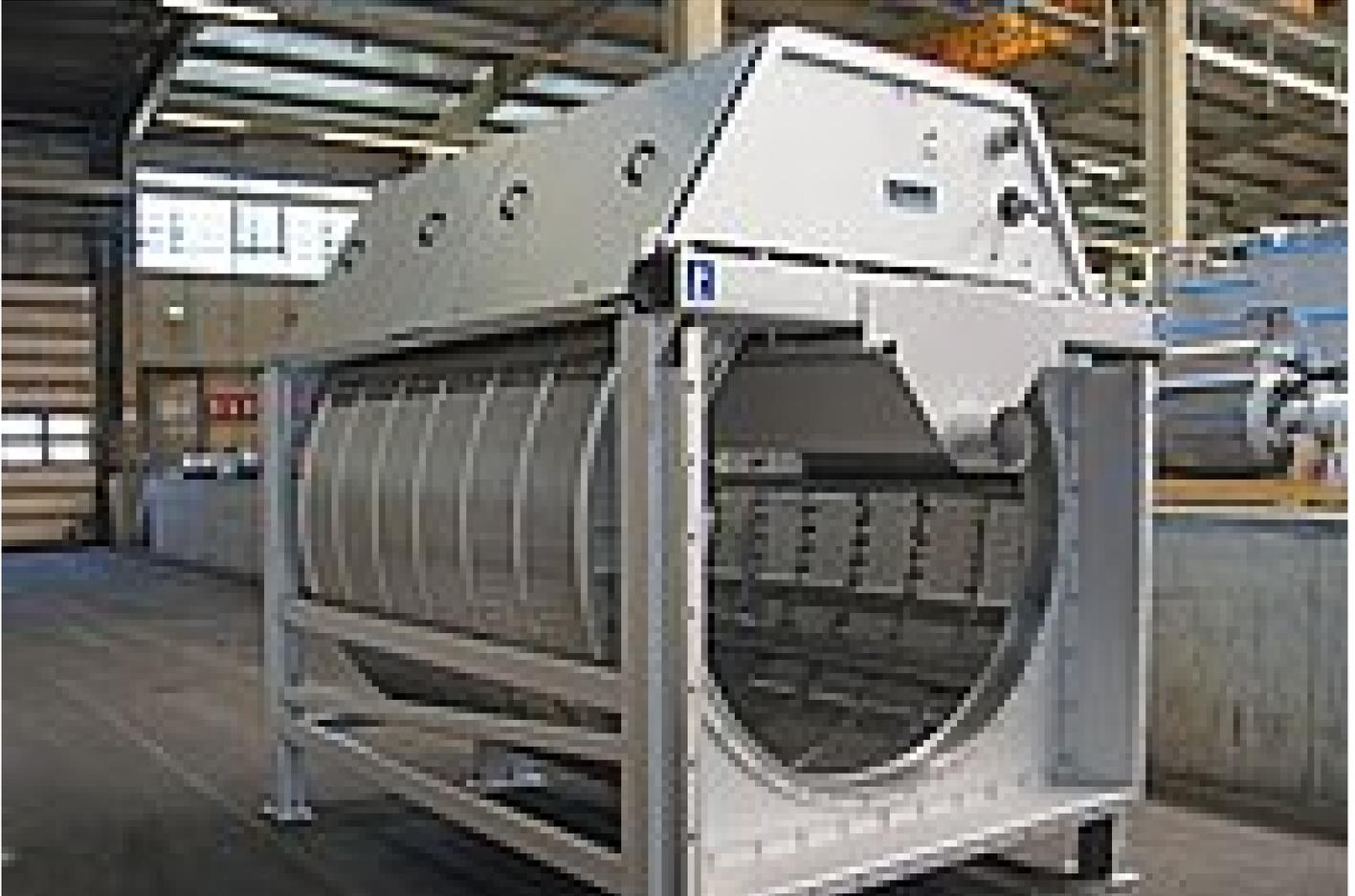
El tamiz de tambor LIQUID de HUBER es una máquina de tamizado, la cual está disponible en diferentes modelos y así es adecuada para diferentes aplicaciones de la separación sólida líquida. **El tambor horizontal es equipado según el uso con mallas, perfil en cuña o chapa perforada.**
