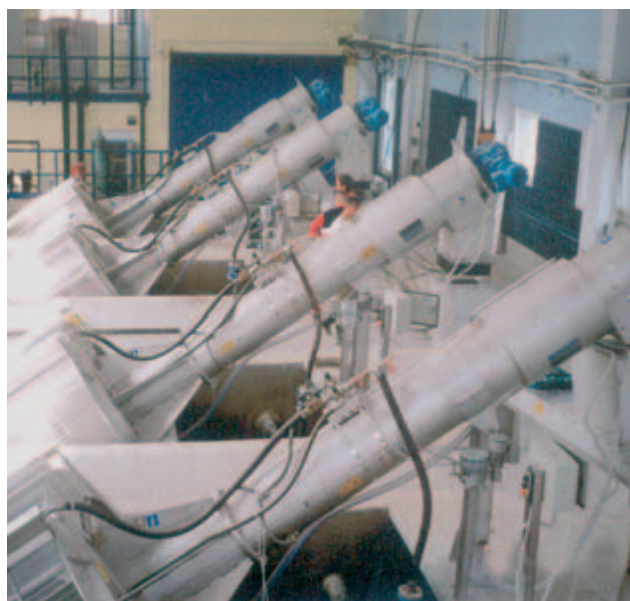
Instalación en paralelo de varios tamices ROTAMAT® Ro 2 con prensa de residuos integrada y sistema de lavado del residuo
