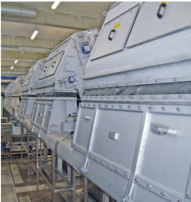
Vista posterior de tamices HUBER EscaMax® con posterior canal de lavado para transporte de sólidos sin desgaste
