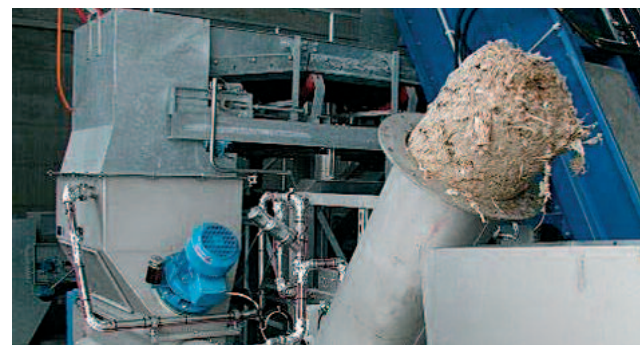
Residuo de desbaste lavado con el WAP SL, sin emisión de olores y compactado al 50% de MS
