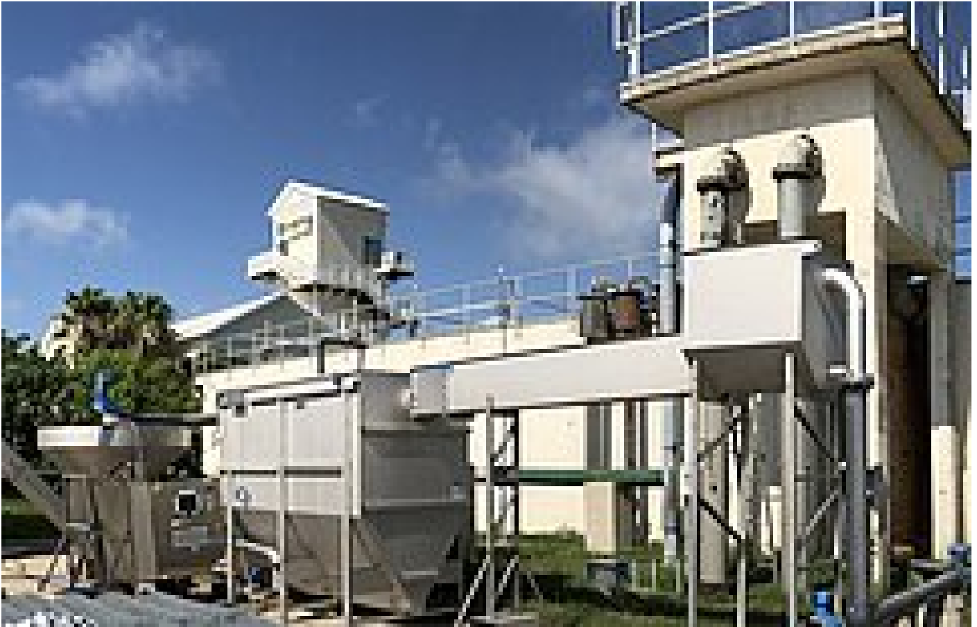
Banco de pruebas para determinar el rendimiento de separación del desarenador HUBER GritWolf® a 40° C en South Padre Island, Texas
