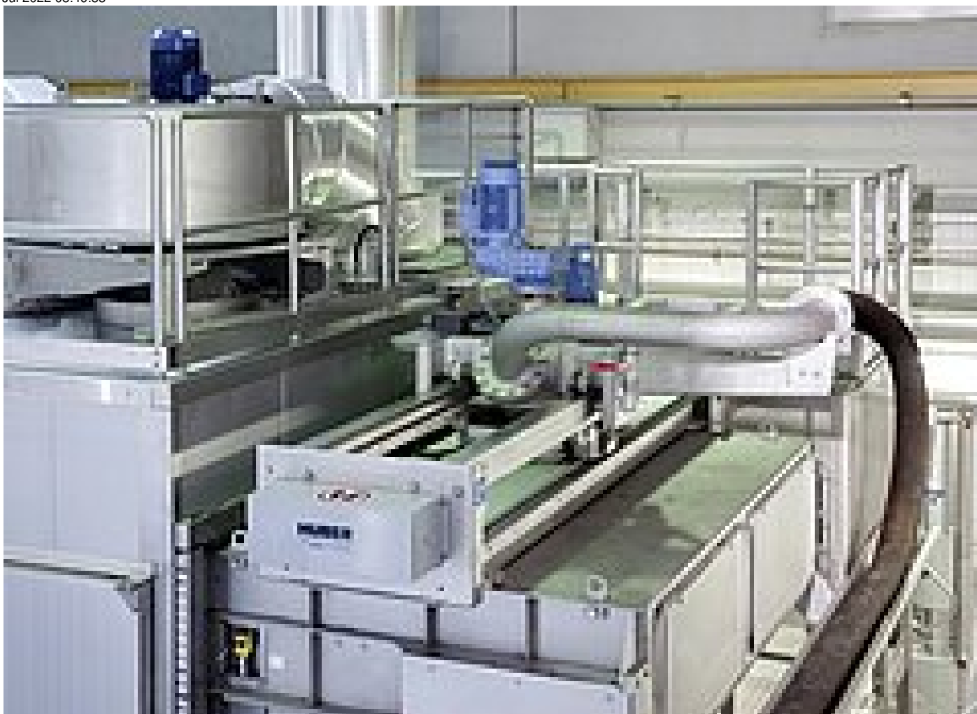
Figura 3: Granuladora HUBER para la alimentación homogénea del lodo Con persiana enrollable cubierta para la reducción del aire de salida
