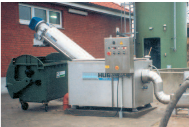
Planta de recepción de fosas sépticas ROTAMAT® Ro 3.1 con medición de caudal, identificación del cliente y muestreo automático.
