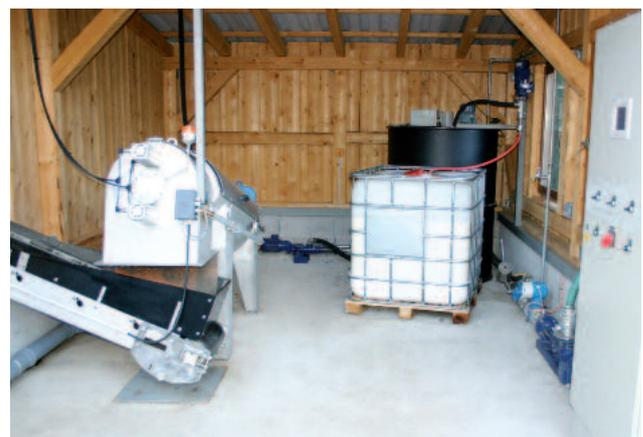
Instalación completa de una RoS 3Q 280 en 12 m<sup>2</sup>
