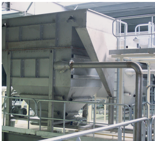
«КРОНОСТАР», Россия Воздушно-напорная флотация HDF-7 Производительность 70 м3/ч
