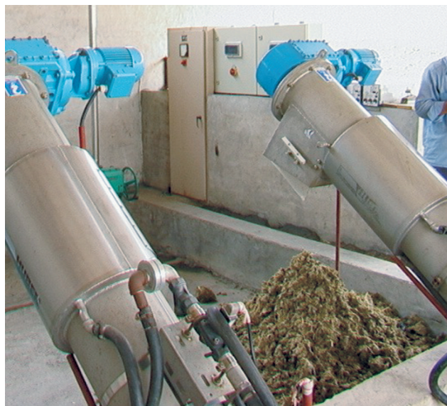
Бумажная фабрика Lingoang, Китай: механическая очистка при помощи барабанной решётки HUBER ROTAMAT® Ro 2, с прозором 1 мм, Извлечение твёрдых включений > 60 %
