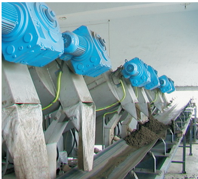
Бумажная фабрика Lingoang, Китай: обезвоживание первичного и биологического осадков до содержания СВ > 28 % при помощи шнекового пресса HUBER S-PRESS®
